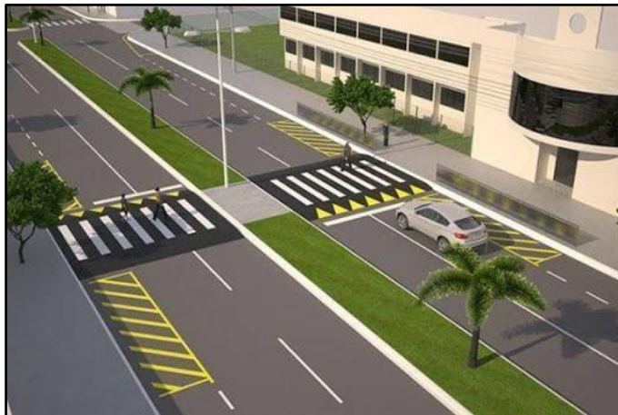
FIGURA 66 - Travessia composta por lombofaixas.
