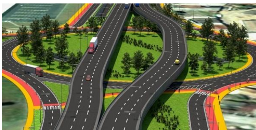
Figura 17: Ilustração de modelo correto de acesso com arborização, faixa de pedestre elevada, iluminação, ciclovias e calçadas para o acesso do Km 62 da Rodovia D. Pedro I.
