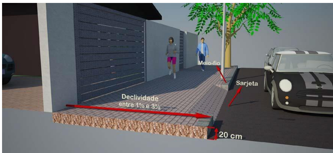
Figura 15: Modelo de calçada acessível e sem interferências.
