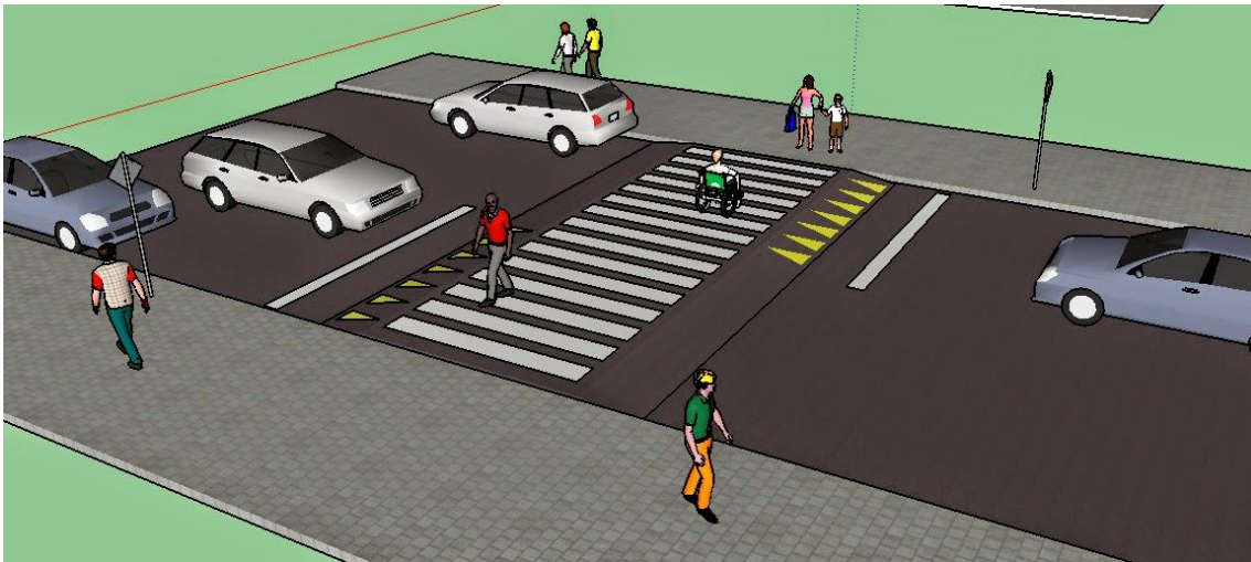
Figura 14: Modelo de faixa de pedestre elevada
